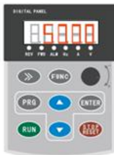
图 1-3 停机参数显示状态 显示停机时的设定频率“50.00”
