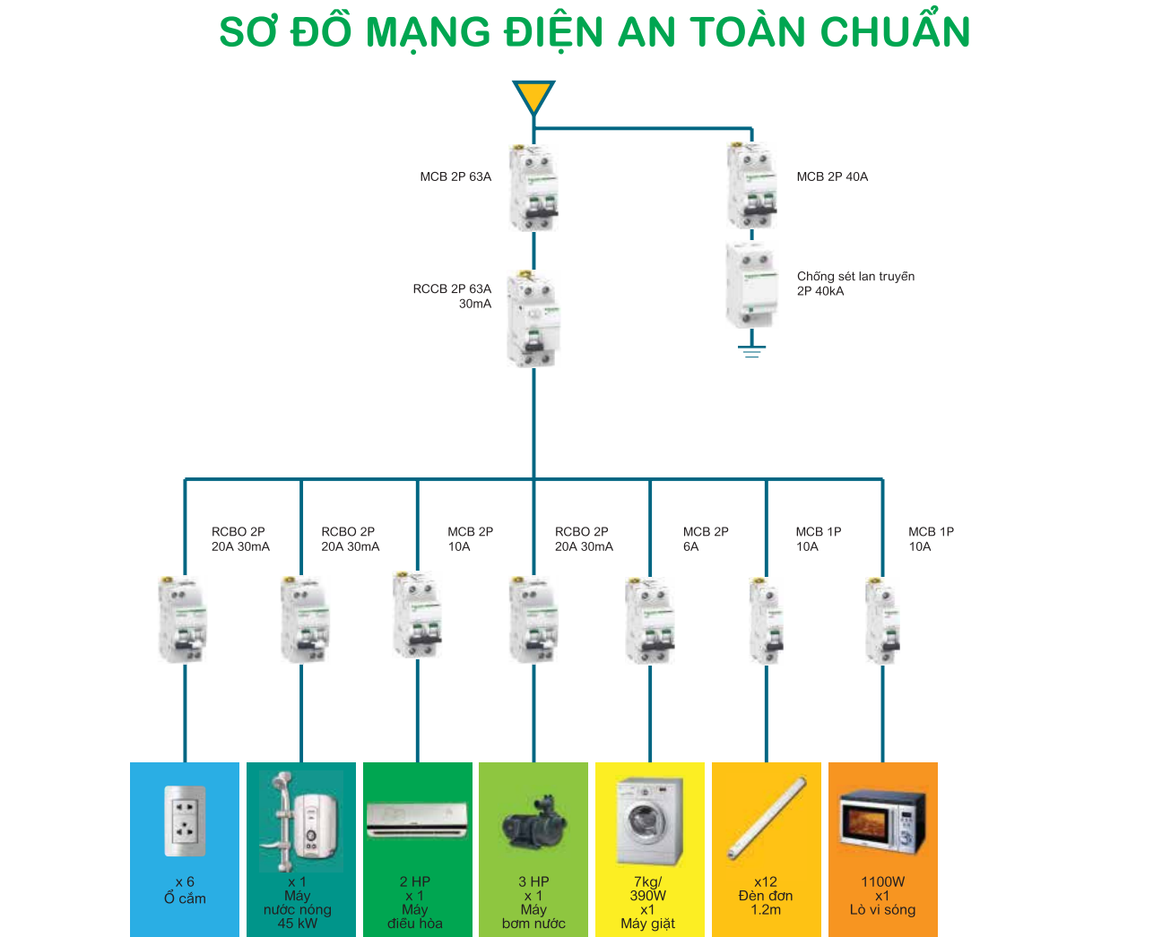
Khuyến cáo lựa chọn cầu dao tự động theo tiết diện dây dẫn
